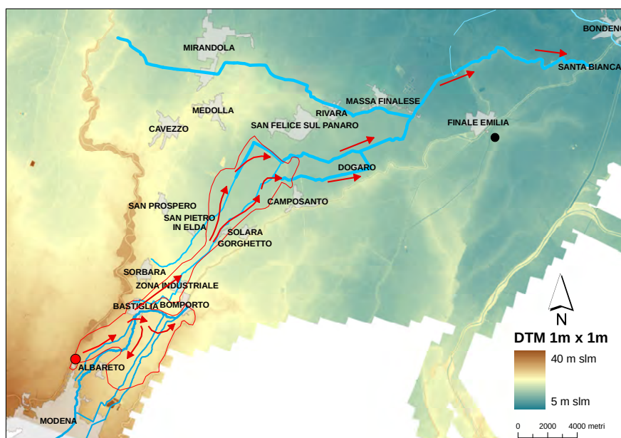
Figura 16 - Schema della propagazione dell'onda di esondazione prodotta dalla rottura dell'argine di San Matteo nella bassa pianura modenese.
